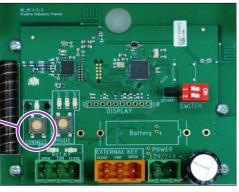
Appui jusqu'à arrêt du clignotement (appairage terminé)
