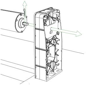
Rentrer le câble moteur au maximum dans le pied pour éviter tout contact avec les lames ou l'axe.
