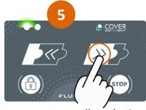
Appui jusqu'à arrêt du clignotement sur le récepteur → Appairage terminé.
