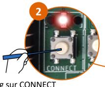
Appui long sur CONNECT jusqu'à clignotement
