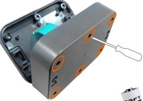
La télécommande doit être alimentée en 3,6V ... continu par une batterie lithium modèle LS14500 de marque SAFT.
