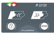
LED rouge clignotante pendant l'ouverture/fermeture : Batterie faible, à remplacer.
