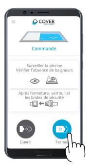
Maintenir l'appui sur ouvrir/fermer pour actionner la couverture
